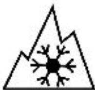
Attenzione: uno pneumatico invernale (M+S) non è necessariamente uno pneumatico "termico", quest'ultimo è identificato, oltre che dalla sigla "M+S" anche dal simbolo cd "three peaks" (il simbolo delle tre vette che racchiudono un fiocco di neve).
