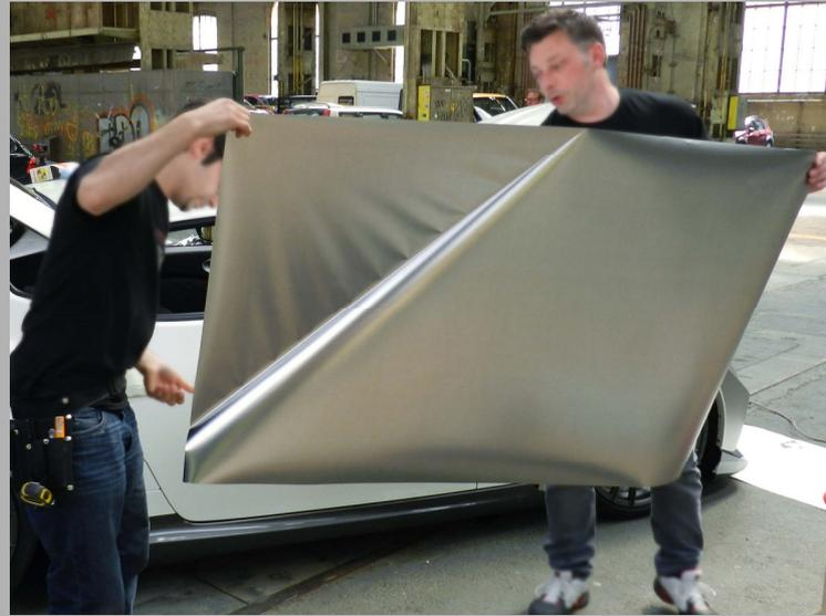
5°- per agevolare la conformabilità del materiale sulle parti curve, scaldare la pellicola con un phon industriale;
