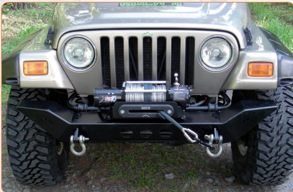
Paraurti anteriore per uso gravoso in acciaio dotato di ganci eavy saldati sullo stesso e supporto per verricello. Il Kit comprende: paraurti con ganci heavy, piastra supporto verricello, bulloneria ed istruzioni di installazione.
