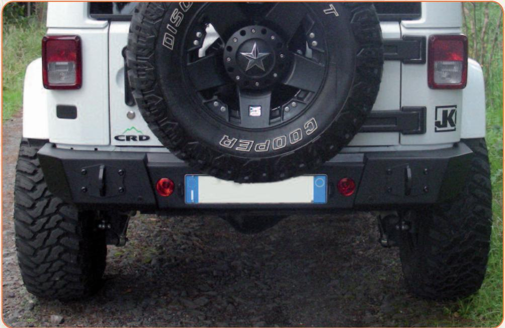
Paraurti posteriore per uso gravoso in acciaio, dotato di alloggiamento per la targa ed i retronebbia.
