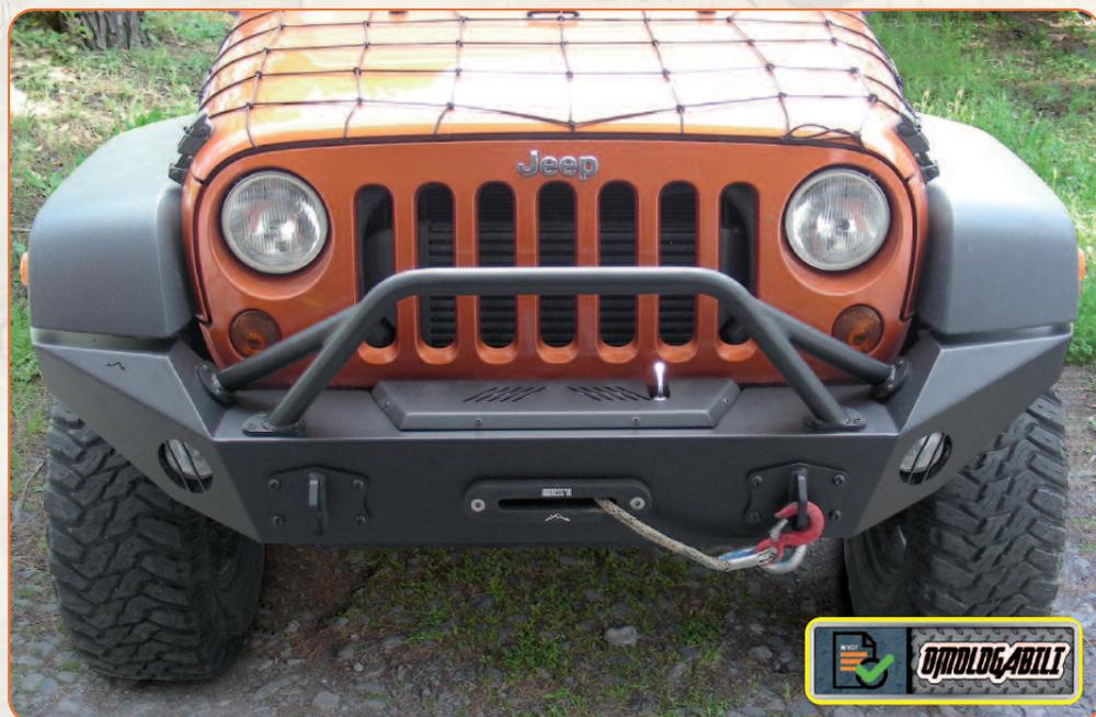
Paraurti anteriore per uso gravoso in acciaio o alluminio per verricello a scomparsa, dotato di alloggiamento per i fendinebbia originali o a LED. Il Kit comprende: paraurti, gancio base per il traino, piastra supporto verricello, copertura verricello, bulloneria, istruzioni di installazione e documenti per l'omologazione.
