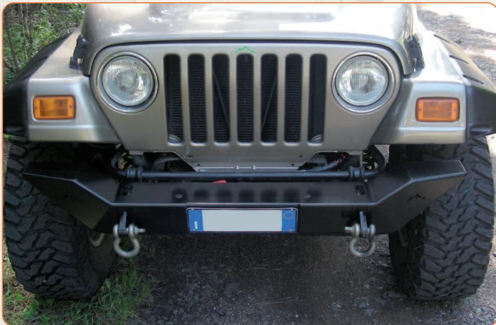
Paraurti anteriore per uso gravoso in acciaio dotato di ganci eavy saldati sullo stesso. Il Kit comprende: paraurti con ganci heavy, bulloneria ed istruzioni di installazione.
