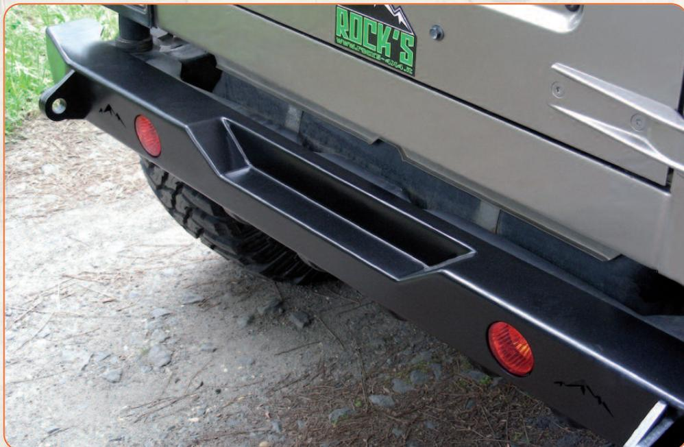
Paraurti posteriore per uso gravoso in acciaio dotato di ganci eavy saldati sullo stesso, dotato di alloggiamento per i retronebbia. Il Kit comprende: paraurti con ganci heavy, retronebbia ed istruzioni di installazione.
