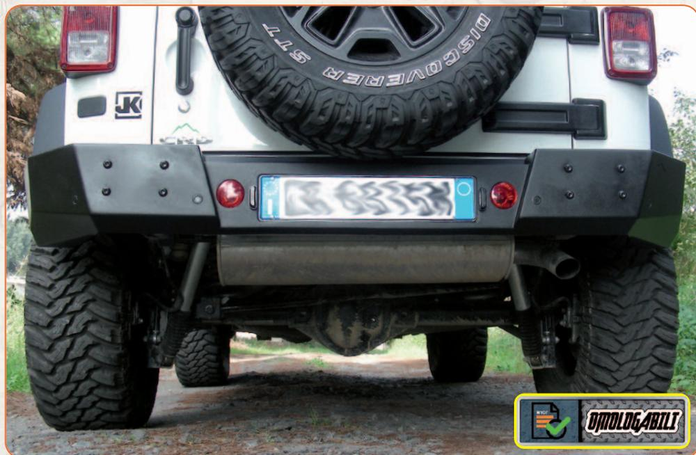
Paraurti posteriore per uso gravoso in acciaio o alluminio, dotato di alloggiamento per la targa ed i retronebbia. (Versione in alluminio solo 9 Kg). Il Kit comprende: paraurti, supporti di ancoraggio, gancio base per il traino, retronebbia, luci targa a led, rilocatore ruota di scorta, bulloneria, istruzioni di installazione e documenti per l'omologazione.
