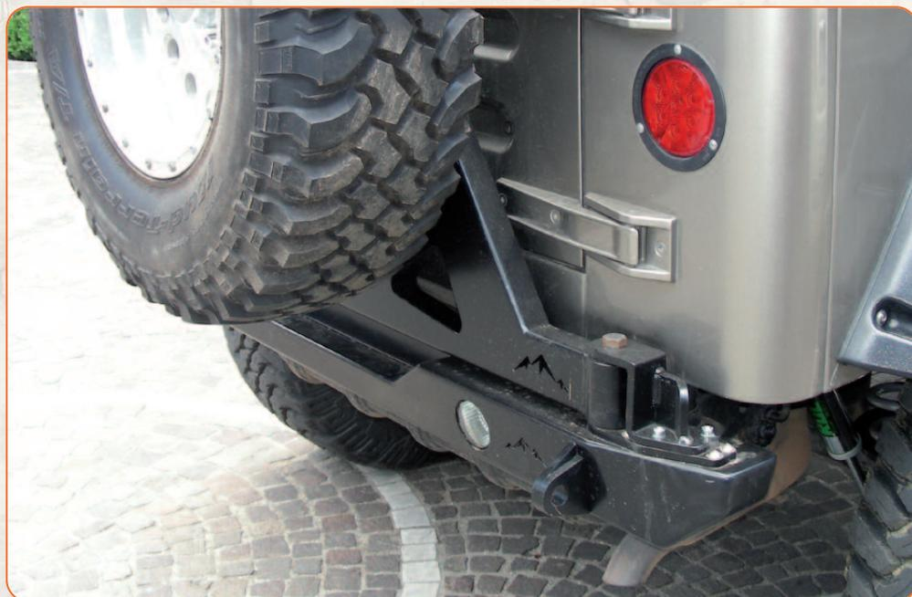
In abbinamento al paraurti posteriore Rock's, il cancello supporto ruota è costruito in acciaio con cerniera e perno di chiusura. Questo prodotto permette di trasportare pneumatici maggiorati senza aggravare il peso sul portellone.
