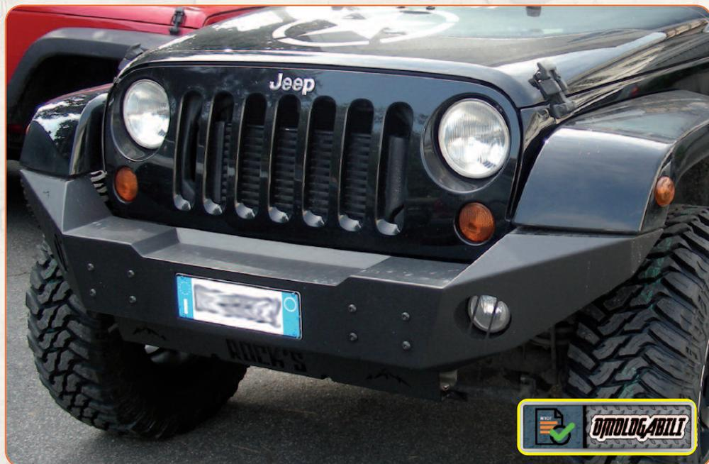
Paraurti anteriore per uso gravoso in acciaio o alluminio, dotato di alloggiamento per la targa ed i fendinebbia originali o a LED. (Versione in alluminio solo 9 Kg). Il Kit comprende: paraurti, gancio base per il traino, bulloneria, istruzioni di installazione e documenti per l'omologazione.
