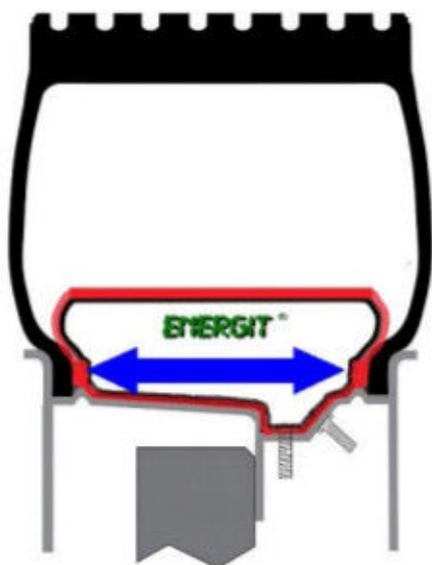
La valvola di **Energit** consente il gonfiaggio e lo sgonfiaggio del solo dispositivo .
