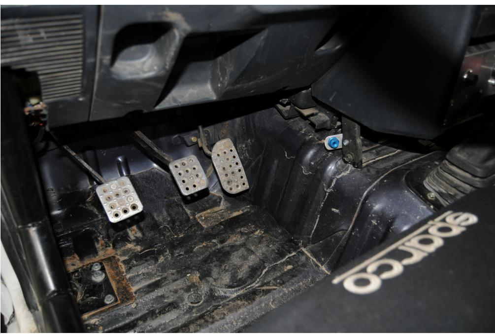
pratico modello in alluminio antiscivolo della OMP di cui è anche il kit composto da tre pedali, con acceleratore standard, adottato come pedaliera per il pilota.
