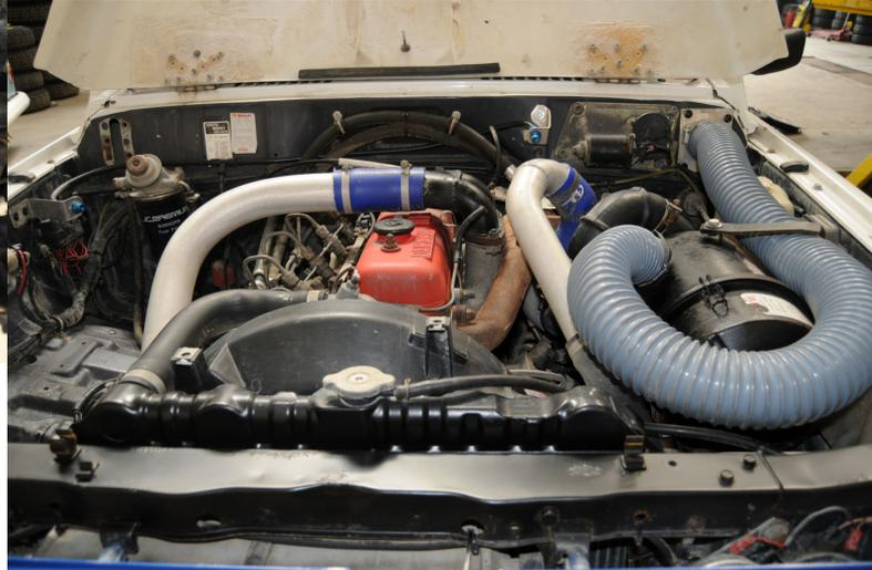
Se il look del Rocky non è stato protagonista di modifiche estetiche particolarmente evidenti, il cuore propulsore di questo 2750 di cilindrata, alimentato a gasolio con pompa meccanica, ha subito invece profonde trasformazioni ad iniziare dalla sostituzione della turbina originale con una più performante soprattutto ai bassi regimi (passando da una pressione di 0,5 a 1,3 bar) sino all'aggiunta di un intercooler di fabbricazione artigianale completo di tubi in alluminio.
