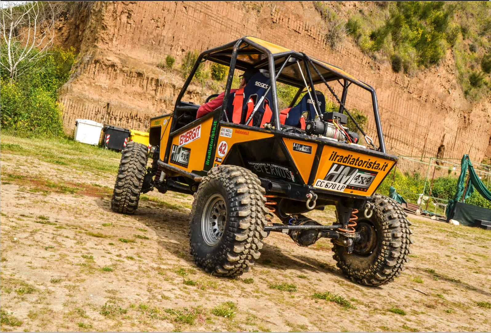
**TRASMISSIONE** - Con una trasmissione granitica come quella delle Mercedes G, in questo reparto c'era poco lavoro da fare, giusto qualche affinamento per dormire sonni tranquilli in caso di situazioni particolarmente estreme. Nel dettaglio le scelte di Mazzilli prevedono l'aggiunta del ponte anteriore della versione 463, in quanto dotato di componenti più grandi e robusti rispetto alla
