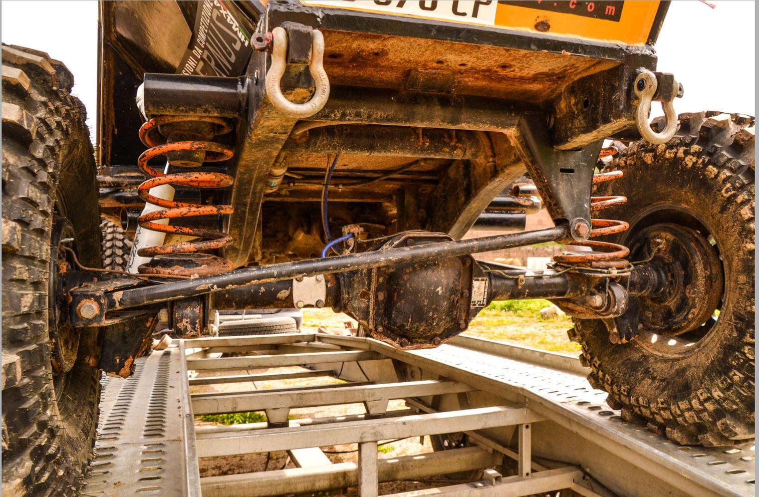
460. Non contento, i semiassi anteriori sono stati sostituiti con elementi RCV rinforzati. Il blocco posteriore è stato saldato, ossia rimane sempre inserito al 100% per evitare possibili distrazioni e perdite di tempo durante la guida intensa nei vari passaggi. Le gomme scelte sono delle Silverstone MT-117 Extreme di misura 35/11,50 montate con camera d'aria interna **antistallamento Energit in versione Extreme**. I cerchi sono degli australiani Baja da 15 pollici con offset -10 e canale 7.
