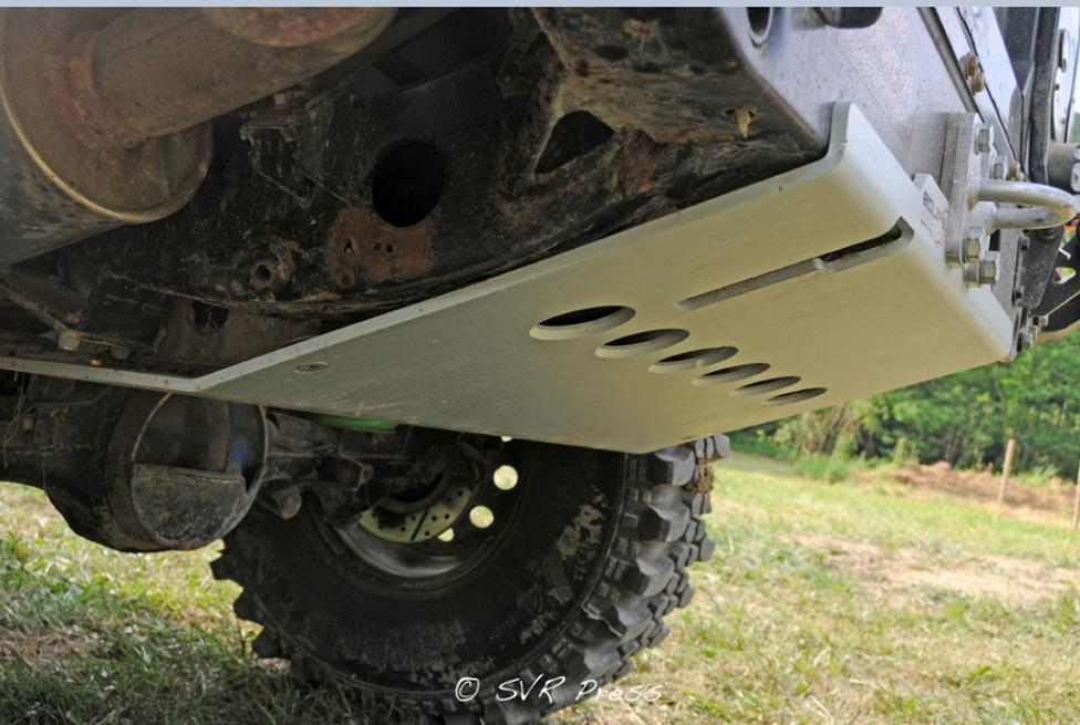
A protezione del serbatoio carburante originale è stata installata una resistente piastra costruita in materiale ergal dall'Equipe 4x4.
