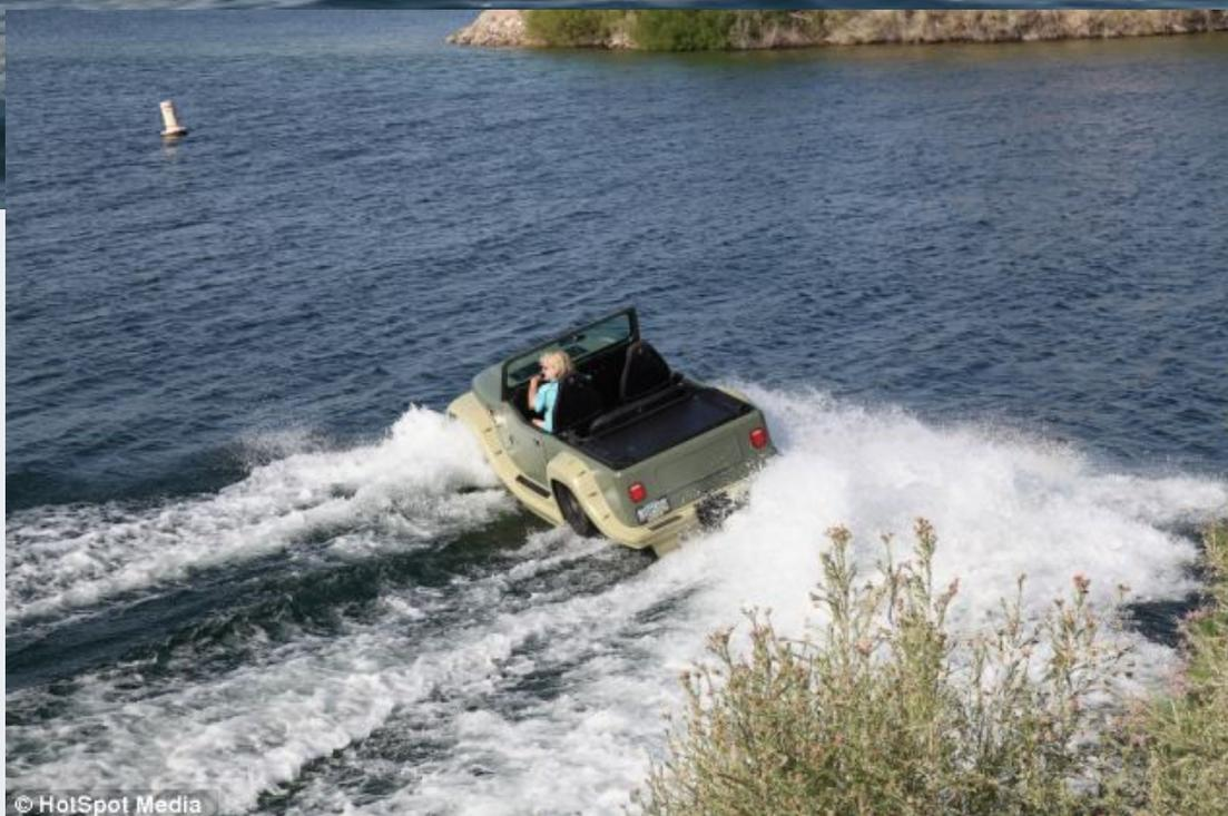
Inoltre la presenza di cellule chiuse in styrofoam, situate all'interno dello scafo, rendono il Panther praticamente inaffondabile. Le ruote retrattili permettono un
