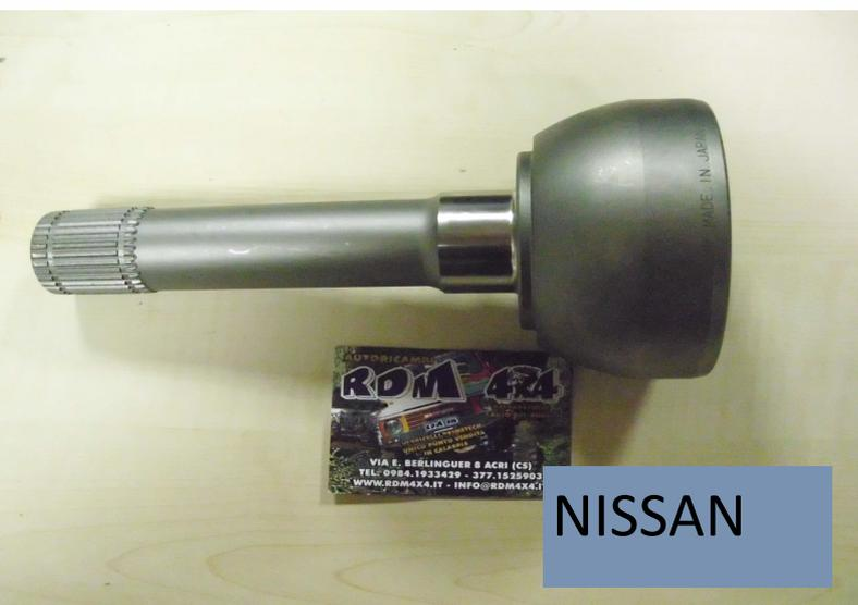
GIUNTO MODELLO RINFORZATO PER NISSAN PATROL GR, Y60 QUESTO GIUNTO E' STATO COSTRUITO CON ACCIAIO CROMO MORBIDENO, AL MOMENTO DELLA COSTRUZIONE LA PARTE ESTERNA SUBISCE UN TRATTAMENTO CHIAMATO (CEMENTAZIONE POLVERIZZATA) QUESTO TRATTAMENTO RENDE IL GIUNTO 2 VOLTE PIU RESISTENTE DEL TRADIZIONALE GIUNTO ORIGINALE NISSAN, LA PARTE INTRENA DELLA GHIERA VIENE COSTRUITA CON UN ACCIAIO PIU RESISTENTE A QUELLA ESTERNA CHIAMATO ACCIAIO 4230 IL PREZZO DEL GIUNTO E DI 210 EURO.
